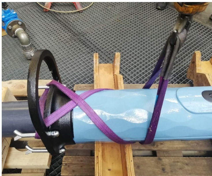
Photo non contractuelle, présentée pour l'exemple d'élingage. Chaussette de protection à conserver lors de la manutention
